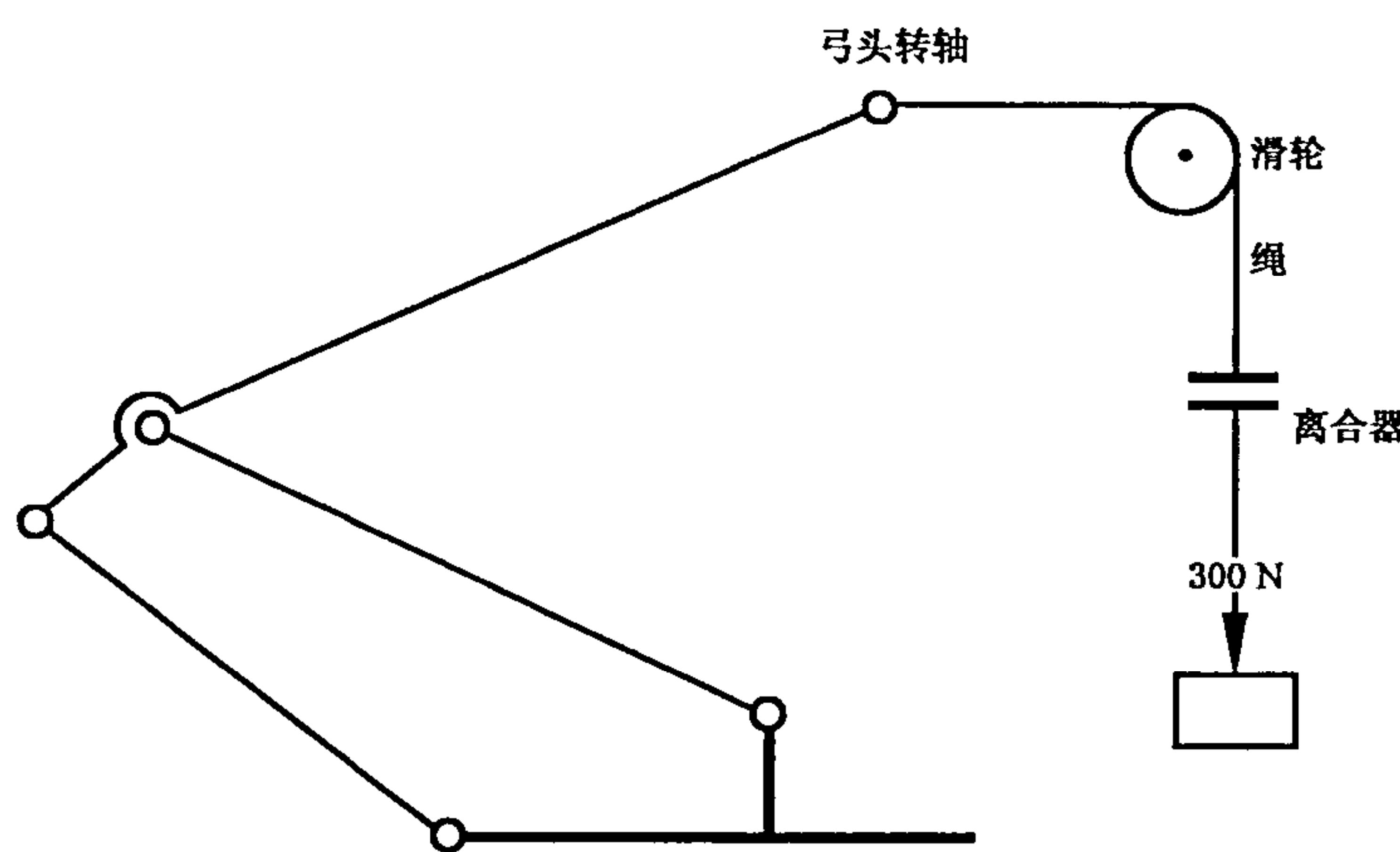
图 1 试验原理图
